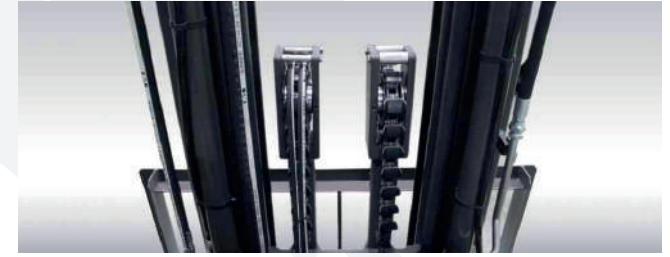
Mástil triple full free equipado con doble cilindro delantero, aumentado enormemente el campo de visión operativo del conductor.
