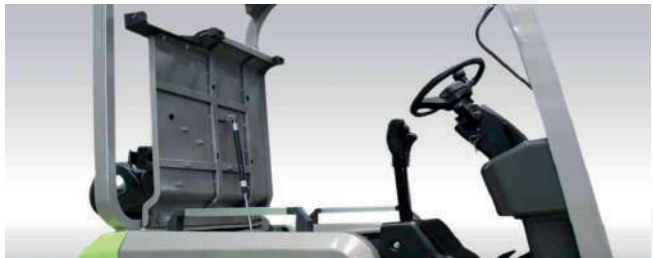
La tapa de la batería adopta un soporte de empujador hidráulico, se puede abrir por completo, es fácil mantener la batería.
