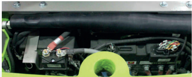
Abra la cubierta pesada de la balanza, puede controlar el mantenimiento eléctrico.
