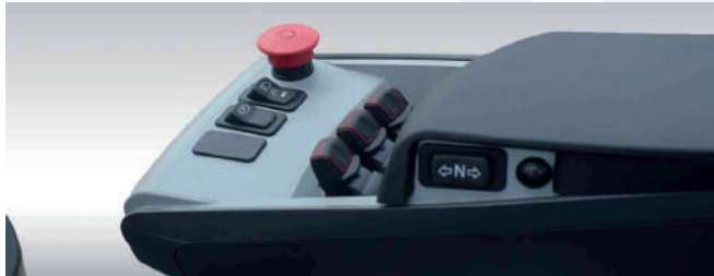
Sistema de control opcional con la punta del dedo configurado para subir y bajar, avanzar, retroceder, interruptor de parada lateral y de emergencia, una bocina, control de iluminación y otros botones de control en uno.
